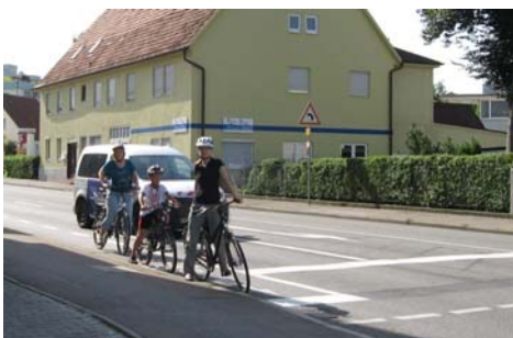
Vorbeifahrstreifen in der Jahnstraße Schutzstreifen werden, wo die Platzverhältnisse es erlauben, bis zur Haltelinie geführt, da insbesondere die Markierung innerhalb von Knotenpunkten eine deutliche Attraktivitätssteigerung für den Radverkehr bedeutet.
